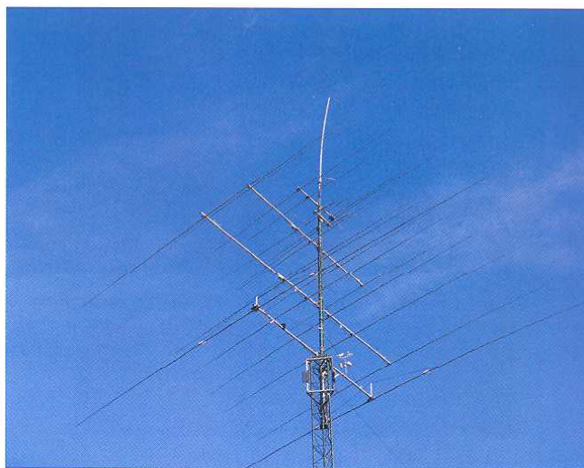
Anteny Wojtka SP2JFF. Na maszcie znajdują się anteny jednopasmowe (monobandery), 2 el. na 7 MHz, 6 el. na 14 MHz, 6 el. na 21 MHz
